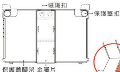
圖左: On-Lap 1102E/H「保護蓋立架 Cover Stand」部位說明
